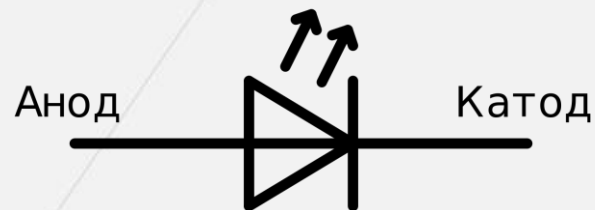
Рис.20 Условное графическое обозначение светодиода в электрических схемах
