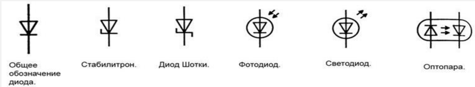
Рис. 1 Условно графическое обозначение полупроводниковых диодов
